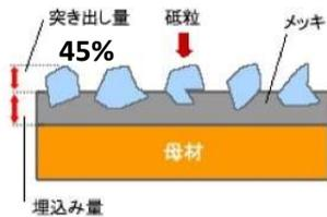
ダイヤモンドヘッド45%露出 研削力MAX
